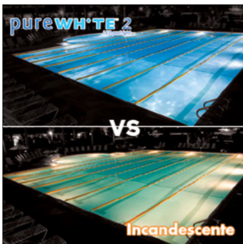
Comparativa entre la iluminación LED y la incandescente
